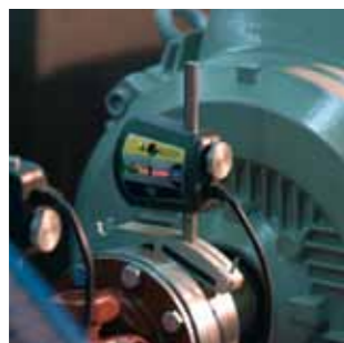
Kuplungsausrichtung mit Lasertechnik.
