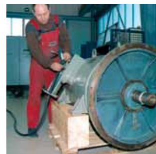
Testlauf eines 500 kw Mittelspannungsmotors.
